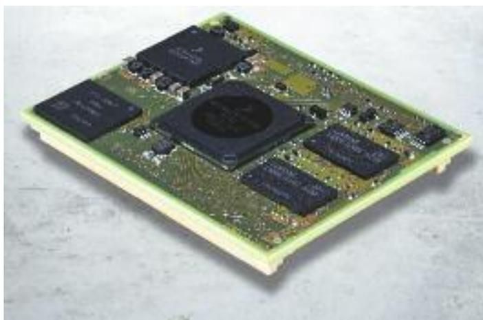
Figure 4: Cortex-A8 module TQMa53
